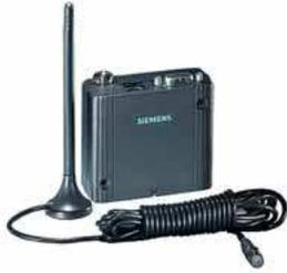
Con este MODEM podemos realizar comunicación via GSM con un S7-200 de manera rápida y sencilla. Este pack contiene todo lo necesario para comunicar el MODEM con un SIMATIC S7-200.
