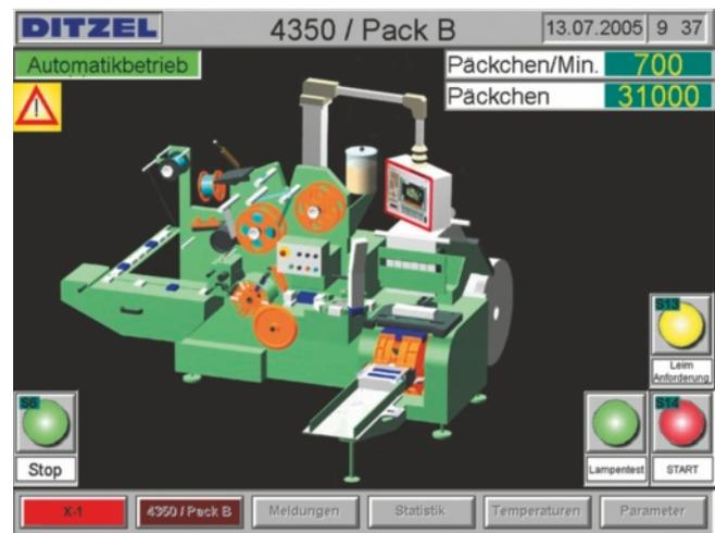
Sinóptico de proceso en máquina de envasado y embalaje
