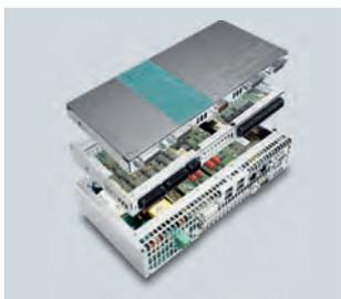
Para tareas especialmente rápidas y de medición, control y regulación en tiempo real, SIMATIC Microbox PC puede ampliarse de forma sencilla y flexible con periferia E/S centralizada. A través de los slots de ampliación PCI-104, los encoders/contadores y los módulos E/S digi-
