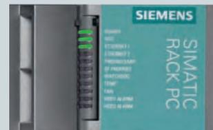
Indicadores LED en el frente para un eficiente autodiagnóstico; por ejemplo, para identificar fácilmente el fallo de un disco duro en el grupo RAID1 mediante HDD1-ALARM o HDD2-ALARM.
