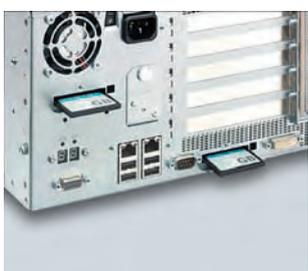
El uso de tarjetas SIMATIC PC CompactFlash (256 MB a 8 GB) en lugar de discos duros garantiza una gestión segura de los datos, especialmente con altas temperaturas o presencia de vibraciones y choques. Y su uso le permitirá ser menos dependiente del mercado, ya que las SIMATIC
