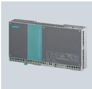
El Microbox PC SIMATIC IPC427C es el potente PC industrial embedded para montaje en perfil, en pared o en libro y resulta idóneo para implementar en poco espacio tareas MSR, HMI y de comunicación rápidas (por ejemplo, directamente en la máquina o en buques).
