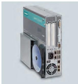
**El SIMATIC Box PC 627B seduce por su alto rendimiento para exigentes tareas de medición, control y regulación a temperaturas ambiente de hasta 55 °C.**
