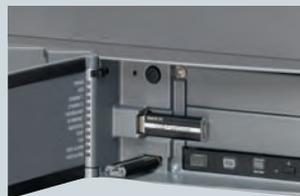
Interfaz USB frontal: Una memoria flash USB enchufada puede operar incluso con la puerta frontal cerrada (por ejemplo, a modo de protección de software) y de este modo queda protegida de posibles infracciones, igual que las unidades de disco accesibles desde el frente y el pulsador CON/DES o Reset.
