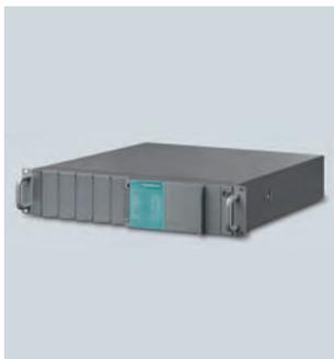
El SIMATIC Rack PC 647B es un robusto PC industrial de diseño supercompacto en formato de 19". Resulta idóneo para implementar en un mínimo espacio tareas de cálculo y visualización como, por ejemplo, procesamiento de datos e imágenes. Con sólo dos módulos de altura y su reducida profun-
