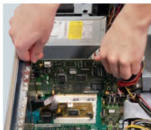
Los SIMATIC IPCs se suministran probados en sistema y con las tarjetas de función ya insertadas. Así se gana tiempo y dinero, sobre todo durante la puesta en marcha. Las tarjetas de función son módulos de PC que contienen ampliaciones funcionales personalizadas para los clientes.
