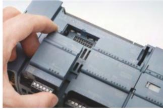
Signal Board para ampliar el número de E/S digitales y analógicas sin necesidad de aumentar el tamaño físico del controlador. Los Signal Modules pueden colocarse a la derecha de la CPU para ampliar la capacidad de E/S digitales o analógicas. A la CPU 1212C se le pueden añadir dos Signal Modules y a la CPU 1214C, ocho. Finalmente, todas las CPU SIMATIC S7-1200 pueden equiparse hasta con tres Communication Modules a la izquierda del controlador, lo que permite una comunicación serie sin fisuras.
