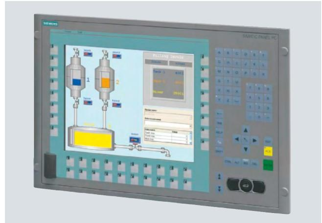
SIMATIC HMI IPC477C-HMI/RTX con manejo táctil
