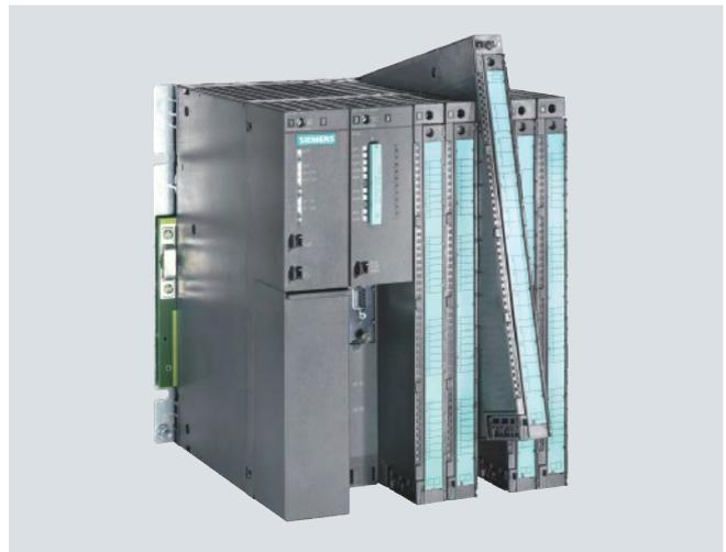
Montaje sencillo del SIMATIC S7-400, basta con enganchar los módulos
