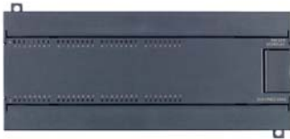
Módulos de entrada/salida
